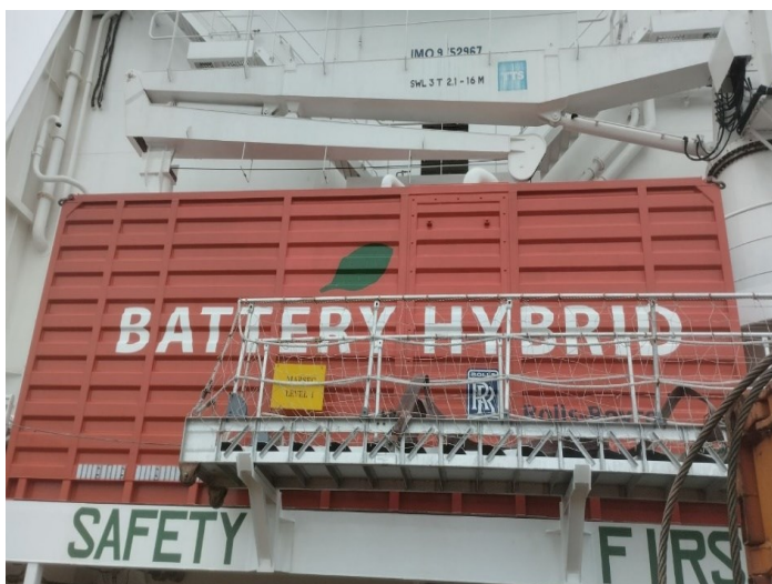
Рисунок 3 – Загальний вигляд контейнера з АБ
