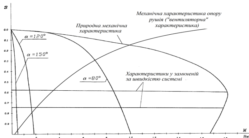
Рисунок 1 – Типові механічні характеристики електрорушіїв БПА ( s – ковзання, в.о., M – момент двигуна, Нм, \alpha – кути керування, град.)
