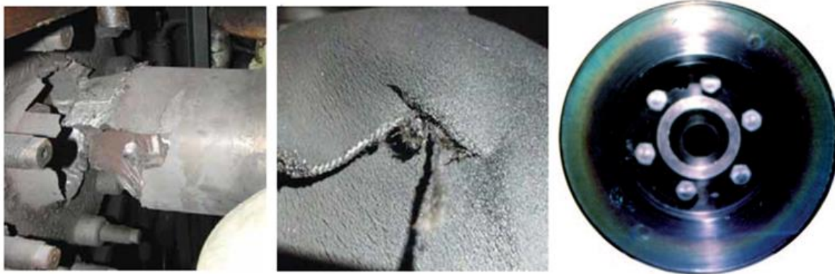
Рисунок 1 – Руйнування гребного валу та гуми муфти, перегрів демпфера внаслідок розвитку крутильних коливань
