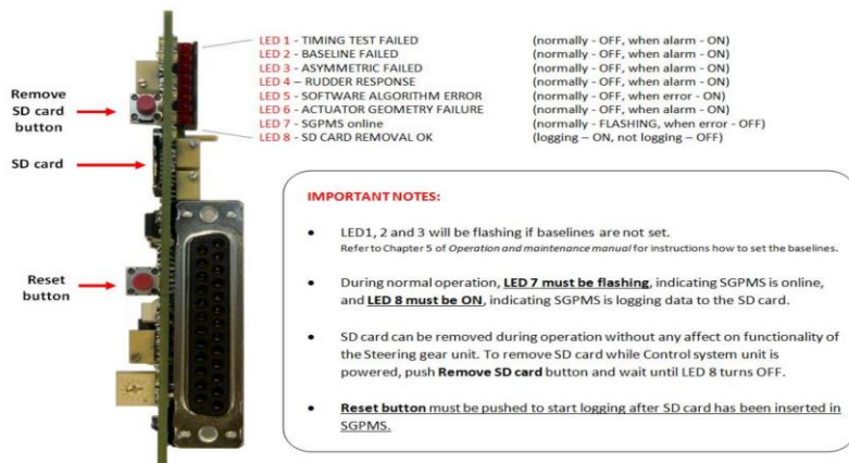
Рисунок 1 - Інтерфейс системи діагностики з оператором
