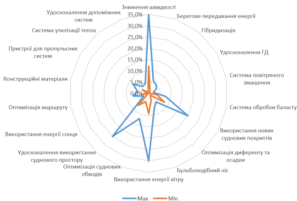
Рисунок 2 – Способи зниження шкідливих викидів в атмосферу із суден
