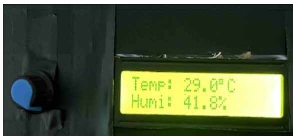
Рисунок 1 – Система комфорту в каюті на базі мікроконтролера Arduino
