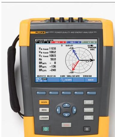
Рисунок 11-Анализатор качества электроэнергии FLUKE
