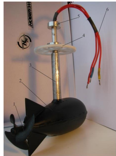
Рисунок 2 – Модель Азипода в собранном состоянии: 1 – гребной винт; 2 – корпус; 3 – баллер; 4 – шестерня редуктора поворота; 5 – муфта ограничителя; 8 – кабель питания.
