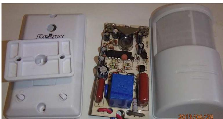
Рисунок 3 – Датчик движения De Luxe YCA1021 в разобранном виде
