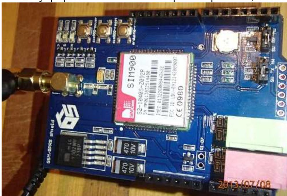
Рисунок 1 – Внешний вид платы LinkSprite SIM900 GSM/GPRS Shield
