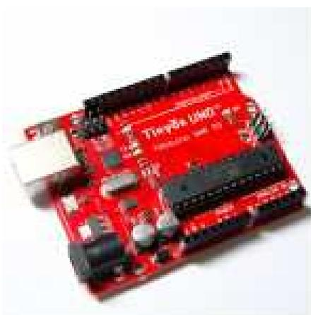
Рисунок 1 – Контроллер построен на ATmega328
